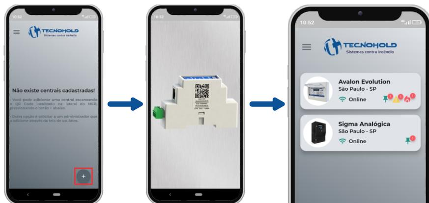
Após escanear o QR Code, a central será exibida na tela inicial do aplicativo, indicando o status de conexão (online ou offline) e o status de eventos (total de alarmes, falhas e avisos).
