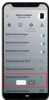
As centrais endereçáveis Tecnohold utilizam o Iris para comunicação com supervisórios de controle remoto (**Software Iris, Fire Alert e Modbus**), exigindo endereço de comunicação quando habilitado.
